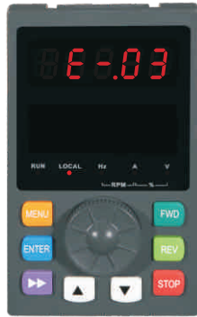
图4-5 故障告警显示状态
