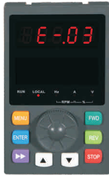
图4-5 故障告警显示状态
