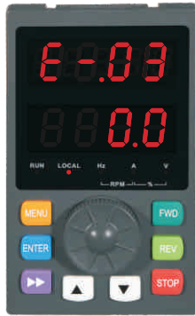
图4-5 故障告警显示状态
