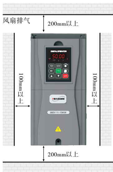
图 3-1 安装间隔距离示意图
